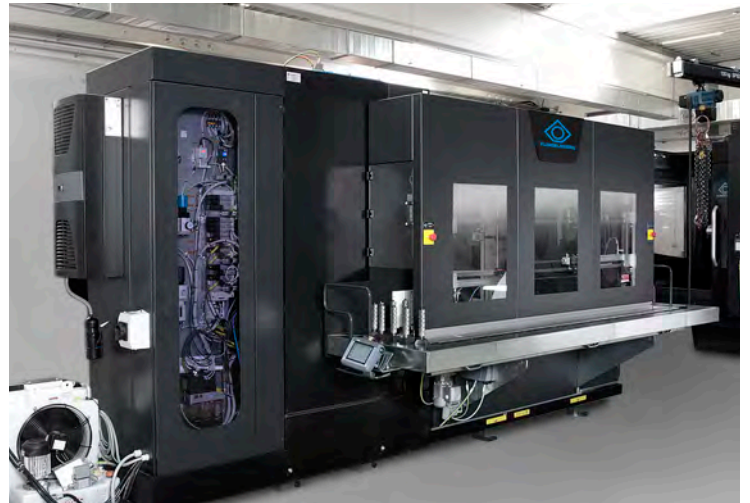
Automationskonzept mit KOENIG CompactLoader – alternativ beliebige externe Automation möglich
